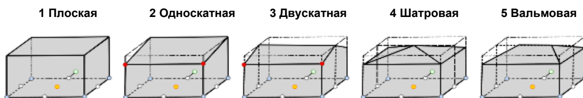
Рисунок 4.1 – Форма крыши здания по его типу
